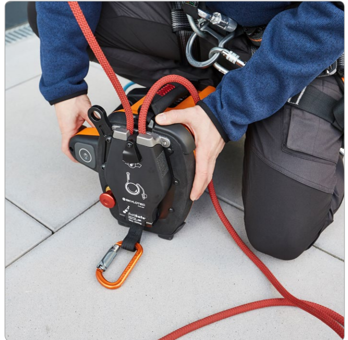
Inserting the semi-static working rope (SUPER STATIC 11.0) into the ACX POWER ASCENDER / Einlegen des halbstatischen Arbeitsseiles (SUPER STATIC 11.0) in den ACX POWER ASCENDER
